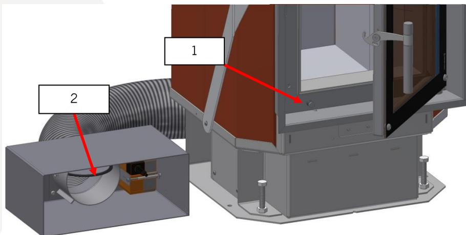
Die Doppelglastüre wird mit Hilfe des Türverschlusshebels geöffnet oder geschlossen. Drehen Sie den Türhebel nach oben wird die Tür entriegelt und kann geöffnet werden. Wird der Türgriff nach unten gedrückt wird die Tür verriegelt und der G05 ist somit betriebsbereit.
