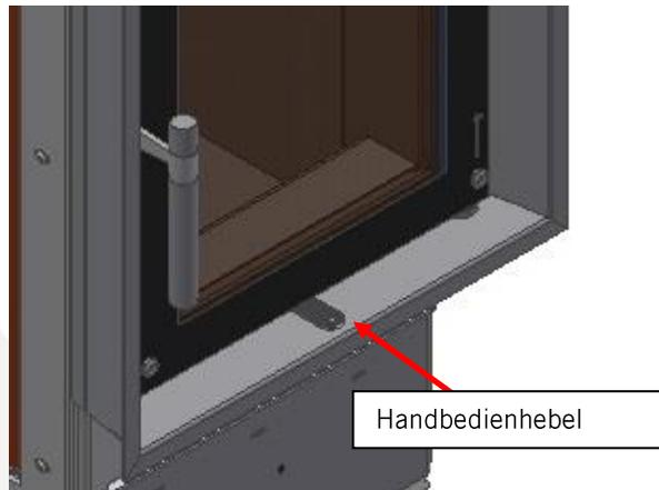
Der Bedienhebel des G05 ist in seiner Funktion gekennzeichnet. Drücken Sie den Hebel nach links wird die Luftzufuhr ganz geöffnet und das Feuer wird groß.
